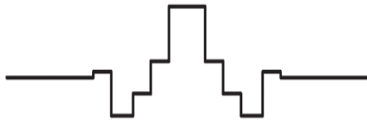
شکل ۵. نمایه ضریب شکست موثر شکل ۴ و تاثیر قطر حفره‌های هوایی [۵].
