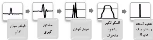
شکل ۴. مراحل روش Pan_Tompkins در یافتن موج‌های R سیگنال ECG
