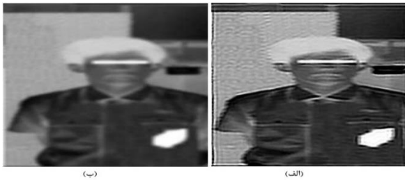
شکل ۲۷. (الف): تصویر ارتقا یافته با الگوریتم پیشنهادی و (ب): تصویر موج‌میلیمتری شبیه‌سازی شده
