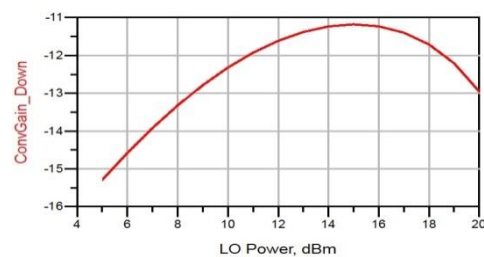
شکل ۷. تغییرات بهره تلفاتی ناشی از انتقال فرکانسی به ازای افزایش توان نوسان ساز محلی
