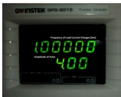
شکل ۱۴. دامنه و فرکانس تغییرات بار خروجی در تست های آزمایشگاهی
