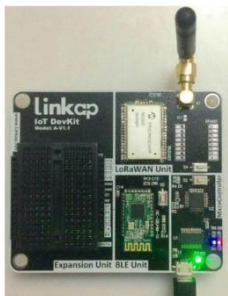
شکل ۱۱. برد توسعه لینکپ در حال عملکرد و اتصال به رایانه
