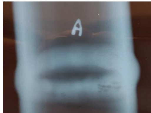
شکل ۱۶. فیلم رادیوگرافی مربوط به لوله شماره ۲ با قطر ۲،۵ اینچ
