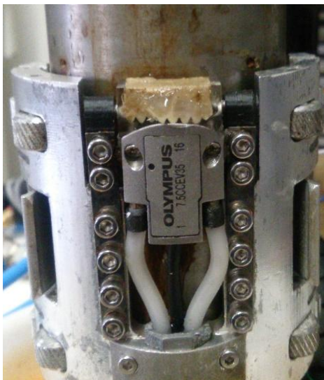
شکل ۱۱. لوله فولادی دارای عیوب تعمدی همراه با اسکندر
