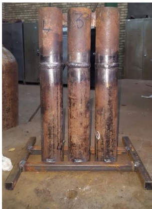
شکل ۱۴. نمایی از سیستم معادل‌سازی شده لوله‌های واتروال بویلر به قطر ۲,۵ اینچ
