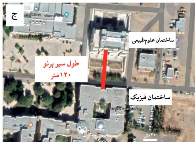
شکل ۹: سیستم اندفا طراحی و راه‌اندازی شده دانشگاه زنجان. (آ) تجهیزات فرستنده و گیرنده نصب شده در ساختمان فیزیک. به منظور مطالعه و کنترل بیشتر بر روی لینک فرستنده و گیرنده در یک مکان نصب شده‌اند. (ب) ایستگاه بازتابنده با قابلیت کنترل از راه‌دور نصب‌شده در ساختمان علوم طبیعی به منظور تامین طول سیر ۱۲۰ متری در یک بار رفت و برگشت پرتو. (ج) نمای هوایی ساختمانی فیزیک و ساختمان علوم طبیعی و مسیر حرکت پرتو اندفا. تصویر از Google Earth.
