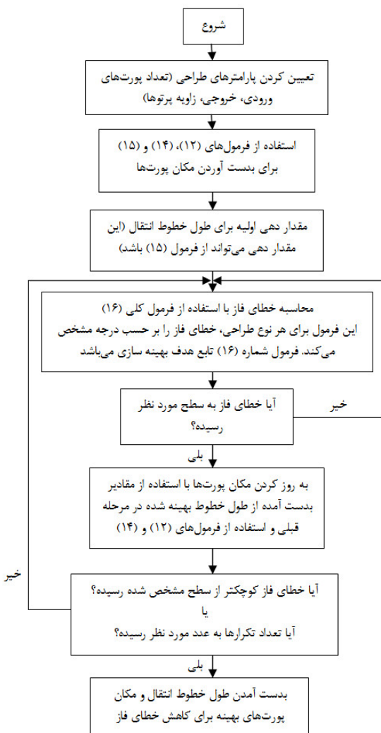
شکل ۶. الگوریتم تبدیل لنز روتمن سه کانونی با استفاده از رابطه بازگشتی از معادلات کانونی
