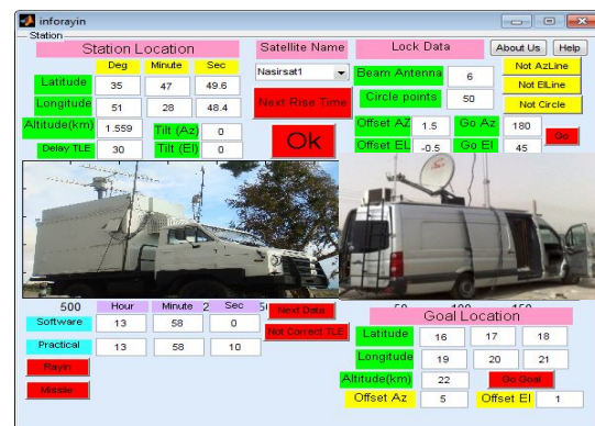
شکل ۳. صفحه کنترل کاربر در نرم‌افزار ردیاب ماهواره KNTUSAT2 [۱۱]
