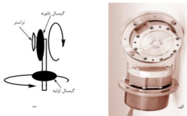
شکل ۴. الف) یک نمونه سیستم گیمبال دو محوره [۸]، ب) جهت چرخش گیمبال‌ها
