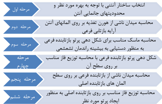
شکل ۴. بلوک دیاگرام روند طراحی روش ارائه شده برای کنترل دامنه میدان بر روی سطح آنتن آرایه بازتابی
