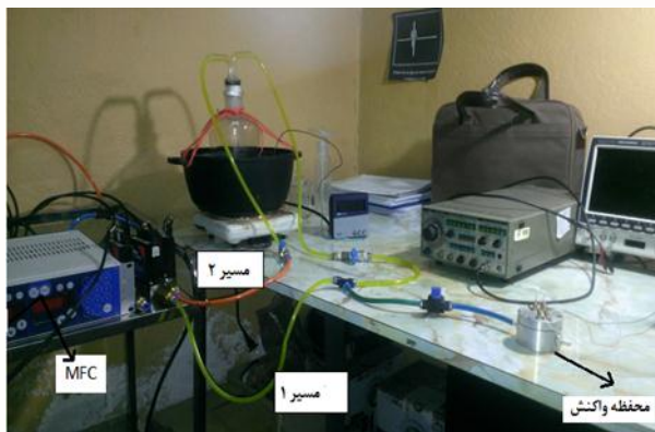
شکل ۹. ابزار آزمایشگاهی راه‌اندازی شده برای تست حسگر
