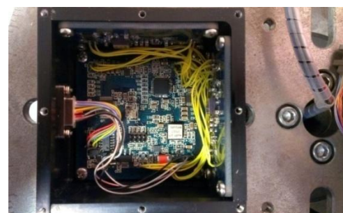
شکل ۶. نمایی از داخل بسته‌ی حسگر ژایروی سه محوره‌ی ممز
