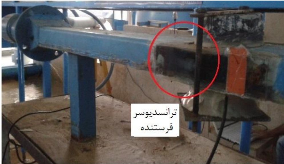
شکل ۳. کانال خط لوله آب و ترانسدیوسرهای فرستنده و گیرنده جاسازی شده درون خط لوله آبی
