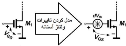
شکل ۳. مدل کردن تغییرات ولتاژ آستانه با هدف اجرای شبیه سازی مونت کارلو. dV_{th} یک منبع گوسی با میانگین صفر و انحراف استاندارد گزارش شده از سوی شرکت سازنده است.
