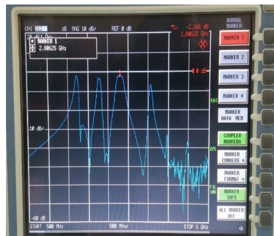
شکل ۱۸. ضریب انتقال اندازه‌گیری شده فیلتر شماره یک با استفاده از تحلیل‌گر شبکه.
