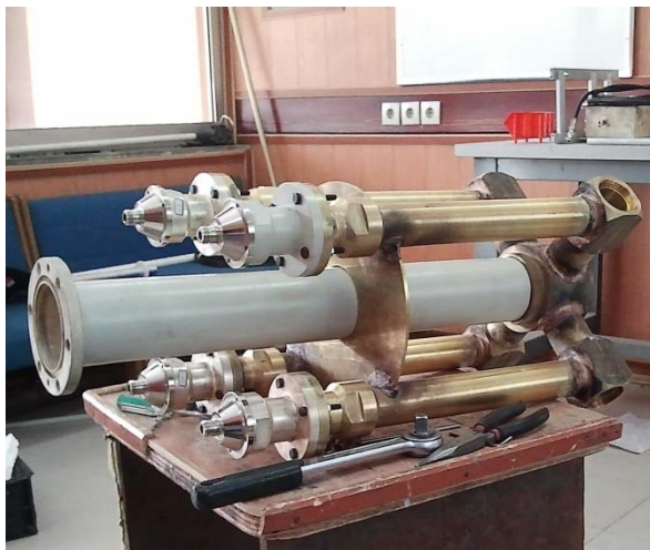
شکل ۷. یک تقسیم‌کننده توان ۴ خروجی برای تست آرایه چهارتایی آنتن مارپیچی
