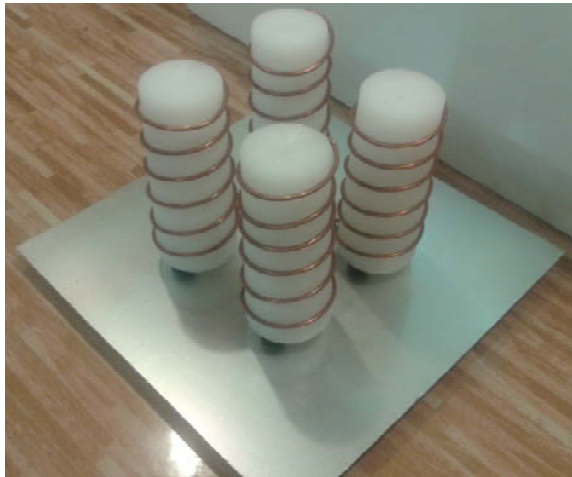
شکل ۲. آرایه ۲×۲ آنتن مارپیچی مود محوری ساخته شده
