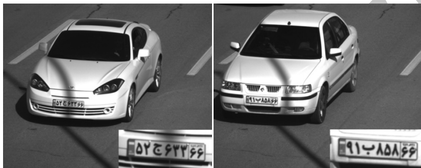
شکل ۷. دو نمونه از تصاویر اخذ شده توسط یک سیستم LPR نصب شده در بزرگراه. این تصاویر برای تولید مجموعه داده کاراکترها استفاده شده است.
